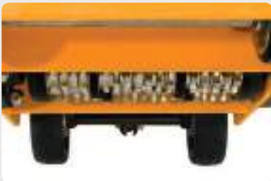
Máxima producción Equipada con fresas de tungsteno. Ancho de fresado especial A: 225 mm
